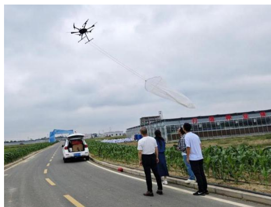
图3-4 旋翼机连续飞行20分钟捕捉昆虫
